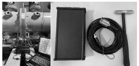
图 12 污秽检测系统实物图
